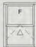
Fixo + Móvel com basculante Single sash and hopper window Fixe + Mobile avec vantail à soufflet
