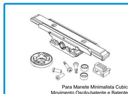
203017 CAIXA TRANSMISSÃO P/MANETE MINIMALISTA CUBIC + MECAN. BASE Para Manete Minimalista Cubic Movimento Oscilo-batente e Batente
